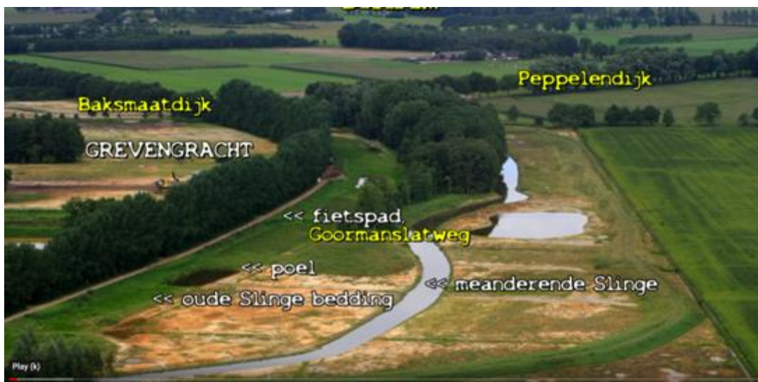
De nieuwe meanderende Slinge, de oude Slinge Loop, het afgegraven perceel langs de nieuwe loop van de Slinge en links de Grevengracht.
